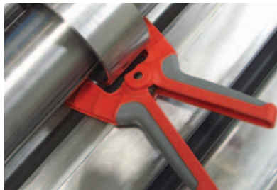
Die Versteifungszange sorgt für eine konstante Rundung
