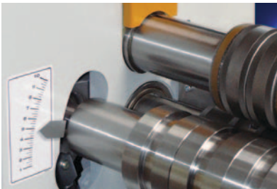
Die Positionsanzeige erlaubt ein wiederholgenaues Einstellen des Rundungsradius
