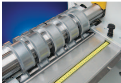
Maschine für Edelstahlbearbeitung mit hartverchromten Rollen und Edelstahl-Kontaktflächen
